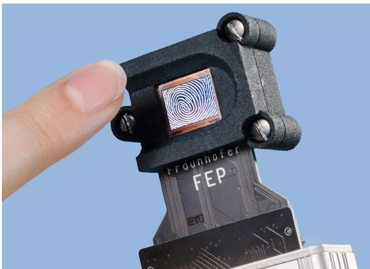
**Fingerprintsensoren basierend auf der bidirektionalen Displaytechnologie**
