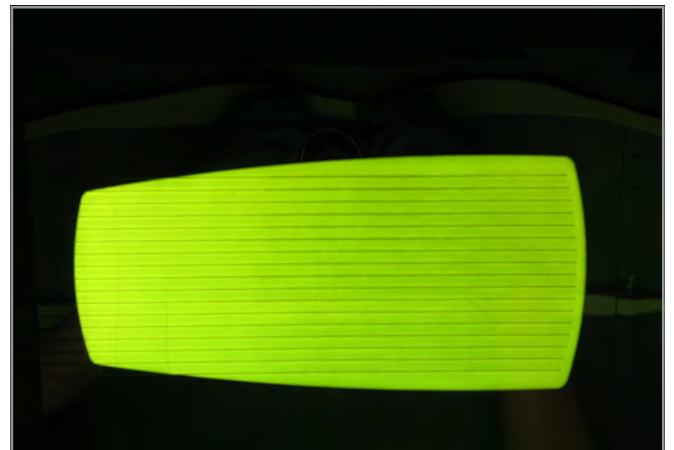
Leuchtende OLED mit einer Leuchtfläche von 206 mm Länge und 70 mm bzw. 95 mm Breite
