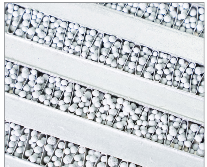
Abb. 3: Wärmetauscher gefüllt mit Aluminium-beschichtetem Zeolith-Granulat
