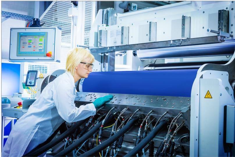
**Bis 50 °C beheizbare, 1200 mm breite Schlitzdüse zum kontaktlosen Beschichten empfindlicher Substrate**
