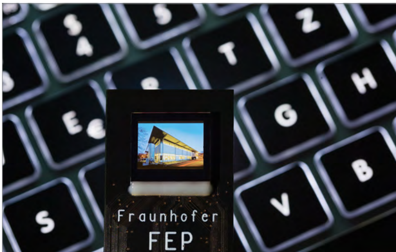
Vollfarbiges SVGA-OLED-Mikrodisplay mit integrierter Bildsensorfunktion
