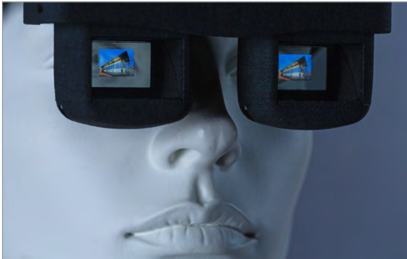
Interaktive, blickgesteuerte Datenbrille mit vollfarbigen OLED-Mikrodisplays
