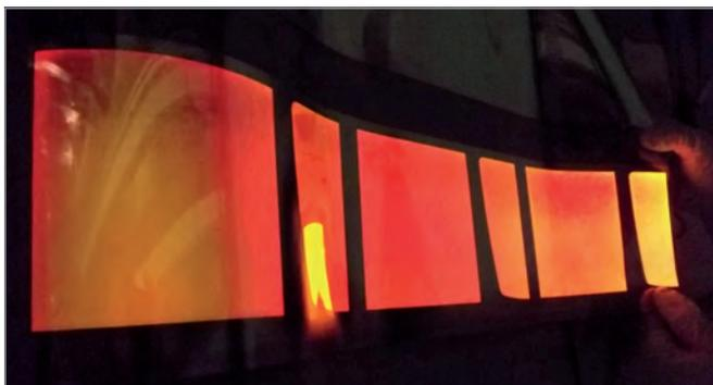
**Flexible OLED hergestellt am Fraunhofer FEP im Rolle-zu-Rolle-Verfahren**
