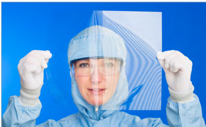
Glas mit Antireflexbeschichtung
